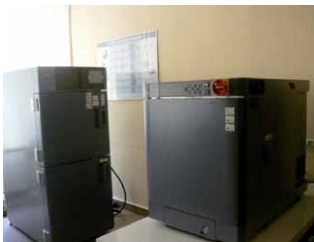
Komora szoków termicznych oraz komora klimatyczna
