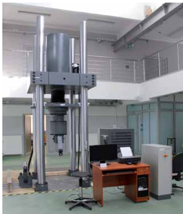
Prasa do badań elementów konstrukcji
