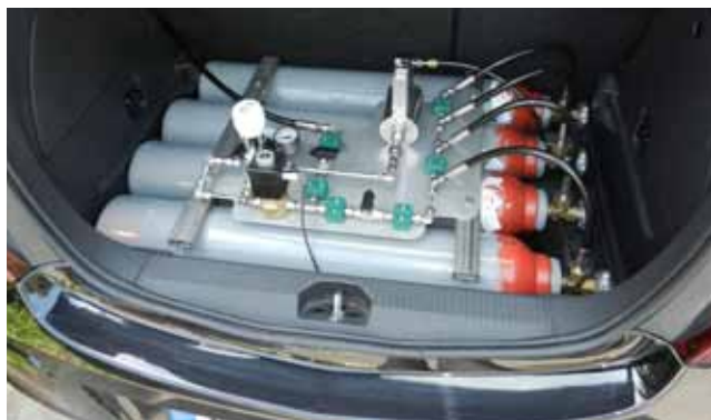
Instalacja wodorowa w samochodzie Opel Corsa D (fot. Mirosław Wendeker)
