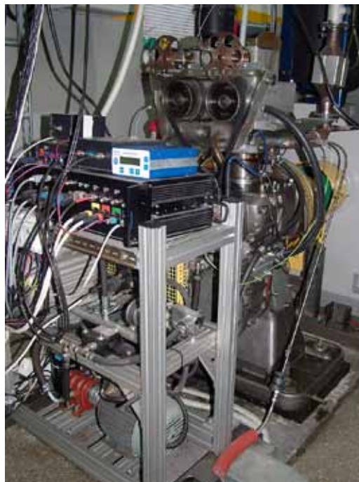
Stanowisko do badań procesów roboczych silnika CAI (fot. Jacek Hunicz)
