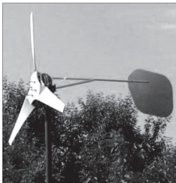
Rys. 4. Kompletna elektrownia wiatrowa podczas prób
