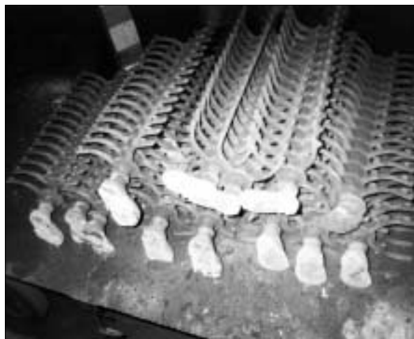
Układy wlewy, pozostałe po grupowym odlewaniu pierścieni tłokowych (PRIMA Łódź)
