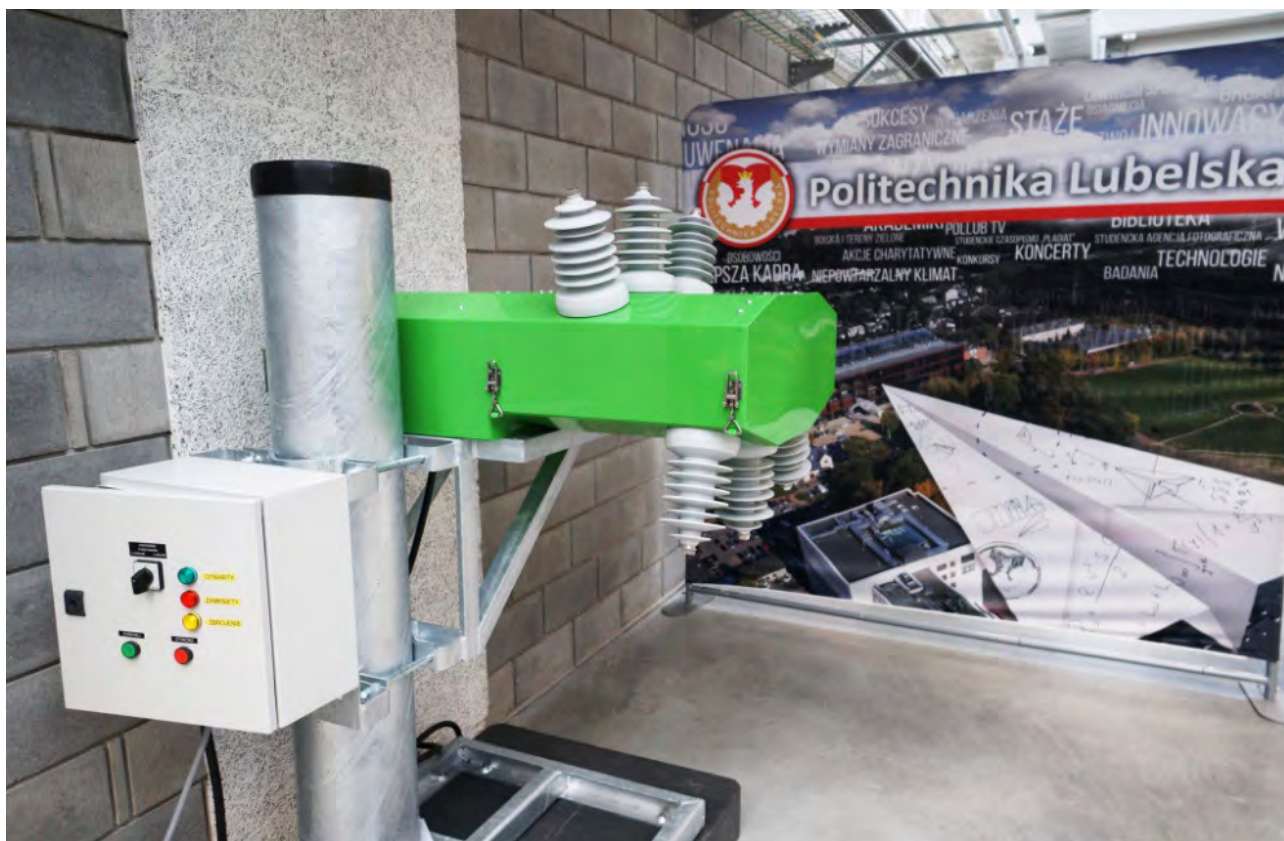
EKTOS – napowietrzny rozłącznik próżniowy
