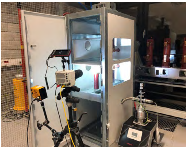
Badanie parametrów próżniowego łuku elektrycznego
