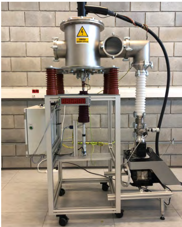
Stanowisko laboratoryjne oparte o tzw. „rozbierną komorę próżniową”
