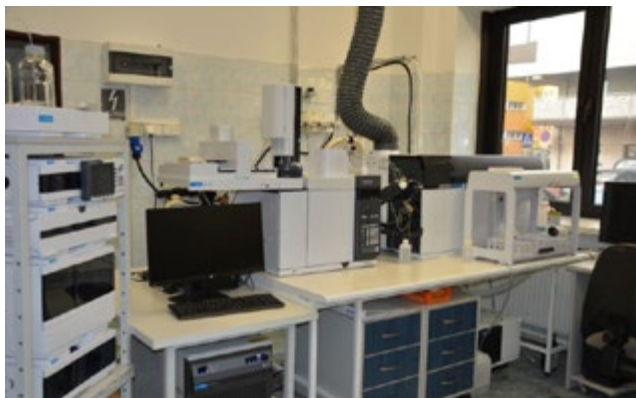
System ICP-MS/MS Agilent 8900 z Układami wprowadzania próbek (GC i HPLC) umożliwiającymi analizę specyficzną zainstalowany w Laboratorium Analiz Środowiskowych WIŚ PL
