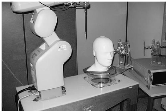
Zdjęcie fantomu do badań rozkładów emisji elektromagnetycznych wywołanych przez telefony komórkowe, Laboratorium UKE w Boruczy
