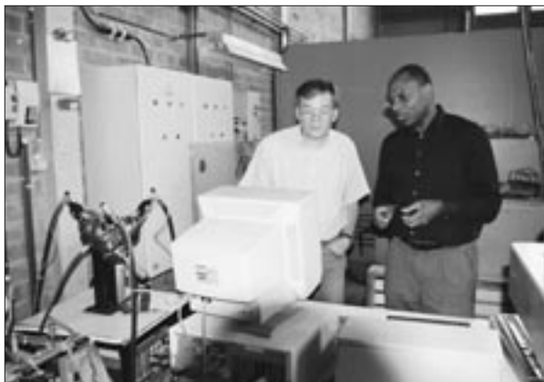
Prof. Tshibangu (po prawej) prezentuje dr Jerzemu Podgórnemu działanie skomputeryzowanego stanowiska do trójosiowego ściskania próbek skalnych
